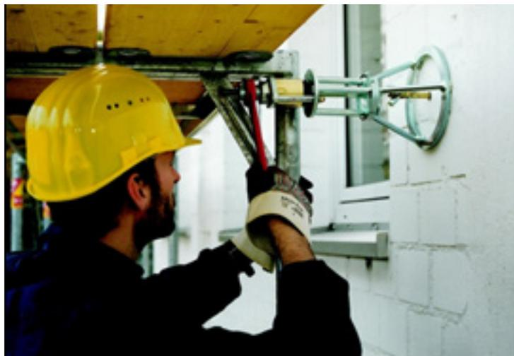
**Geeignetes Dübelprüfgerät**    **Suitable test device for dowels**
