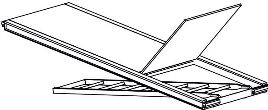
► Aluminium-Leitgangtafel mit integrierter Leiter für sicheren Aufstieg
