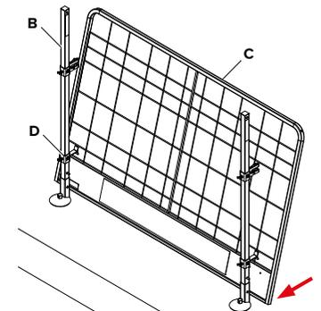
**Schritt 5** Den oberen Rahmen des PROTECTO Schutzgitter G2 (C) so zum PROTECTO Pfosten 130 Variabel (B) drehen, dass das Gitter des PROTECTO Schutzgitter G2 in die Sicherungen (E) einrastet. Die Sicherung (E) am PROTECTO Pfosten muss möglicherweise mit der unverlierbaren Flügelschraube verstellt werden.
