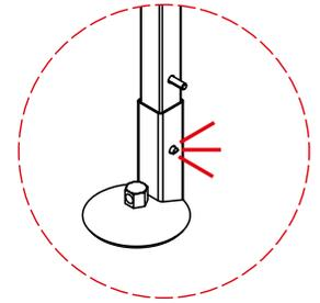
**Schritt 3** Schritt 2 für die andere Pfostenposition wiederholen.
