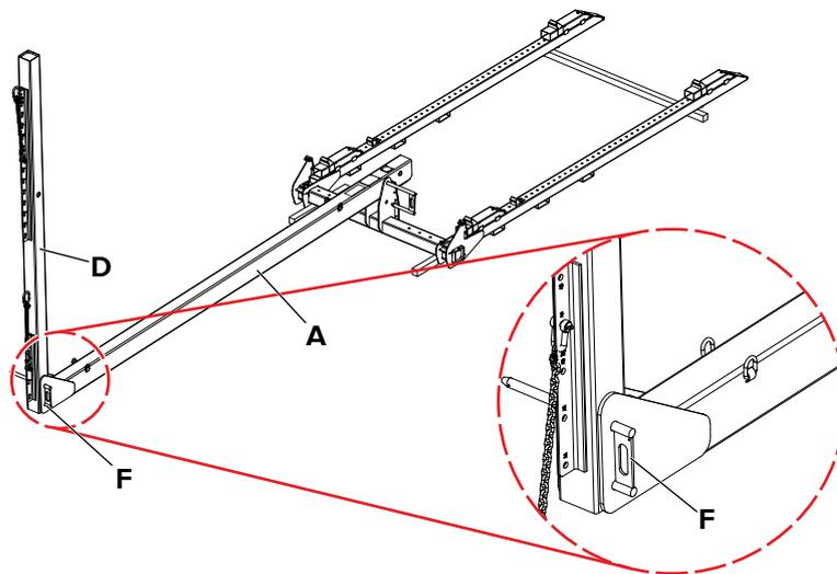
**Schritt 3** Den so errichteten Galgen aus Anschlagtraverse (D) und Vertikalstiel 600 (A) aufrichten.
