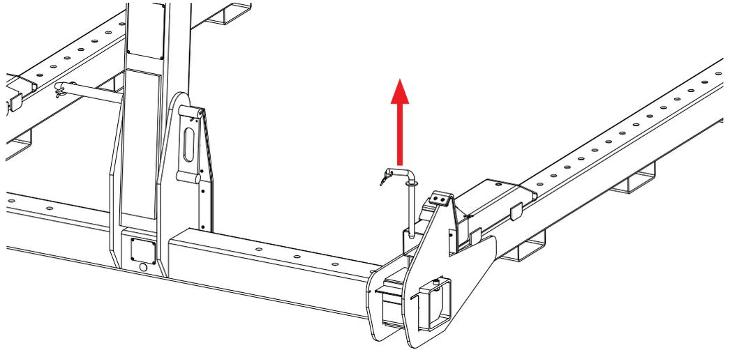
**Schritt 5** Gabelzinken verschieben und mit dem Sicherungsbolzen in der gewünschten Position abstecken. Sicherungsbolzen mit Federstecker sichern.
