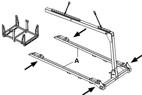
**Schritt 2** Umsetzgabel anheben und im Stapelgestell ablegen. Darauf achten, dass die vorderen Staplerlaschen (B) innen am Grundrahmen des Stapelgestells anliegen.
