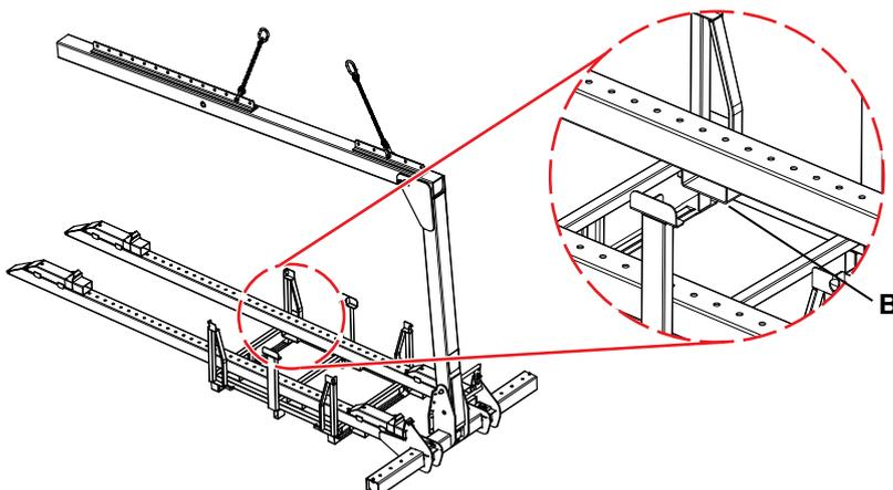
**Schritt 3** Anschlagketten mit dem Kran leicht anziehen.
