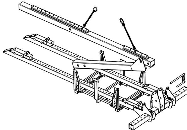
**Schritt 6** Anschlagtraverse in die Aufnahme an der Quertraverse (**E**) einführen. Quertraverse mit dem kurzen Bolzen des Verriegelungsbolzens (**D**) in der unteren Bohrung der Aufnahme abstecken und mit den Federsteckern sichern.
