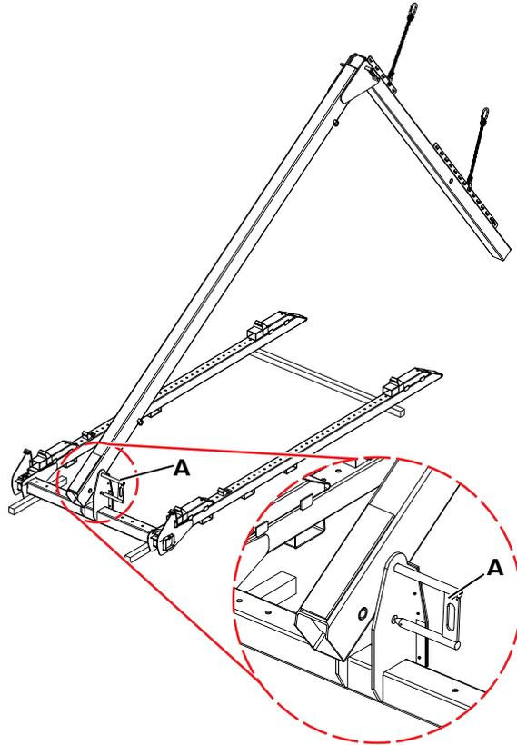
**Schritt 3** Kran mit einem geeigneten Anschlagmittel einseitig im letzten Loch an der langen Anschlagschiene der Anschlagtraverse (**B**) anschlagen.
