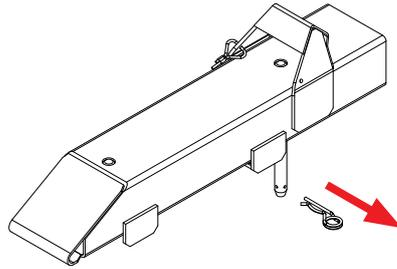
**Schritt 2** Aufsteckschuh ggf. vom Gabelzinken entfernen.
