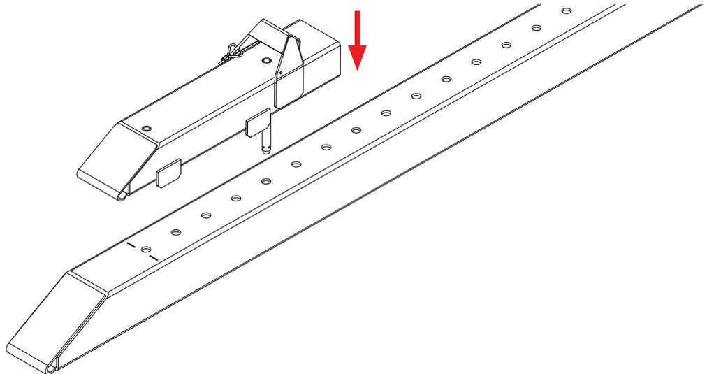
**Schritt 4** Langen Bolzen mit Federstecker sichern.
