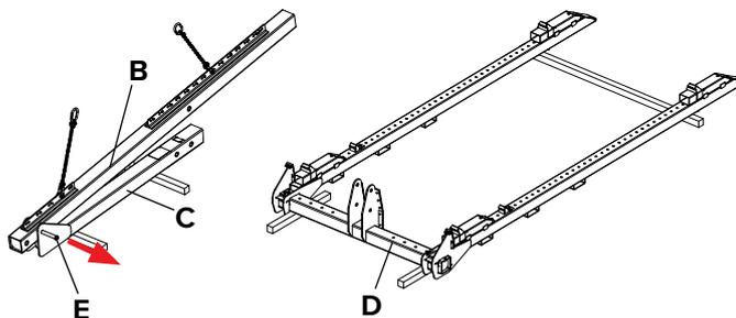
**Schritt 3** Anschlagtraverse (B) seitlich ablegen.
