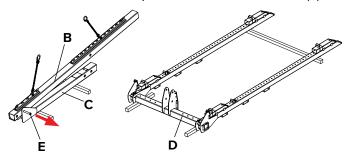
**Step 3** Place the Traverse Beam (**B**) aside.
