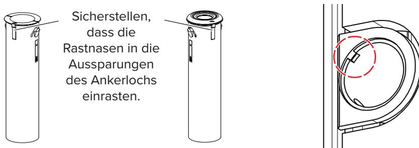
**Schritt 3** Den MANTO G3 Kunststoffeinsatz bis zum Anschlag einstecken. Der Einsatz rastet ein.
