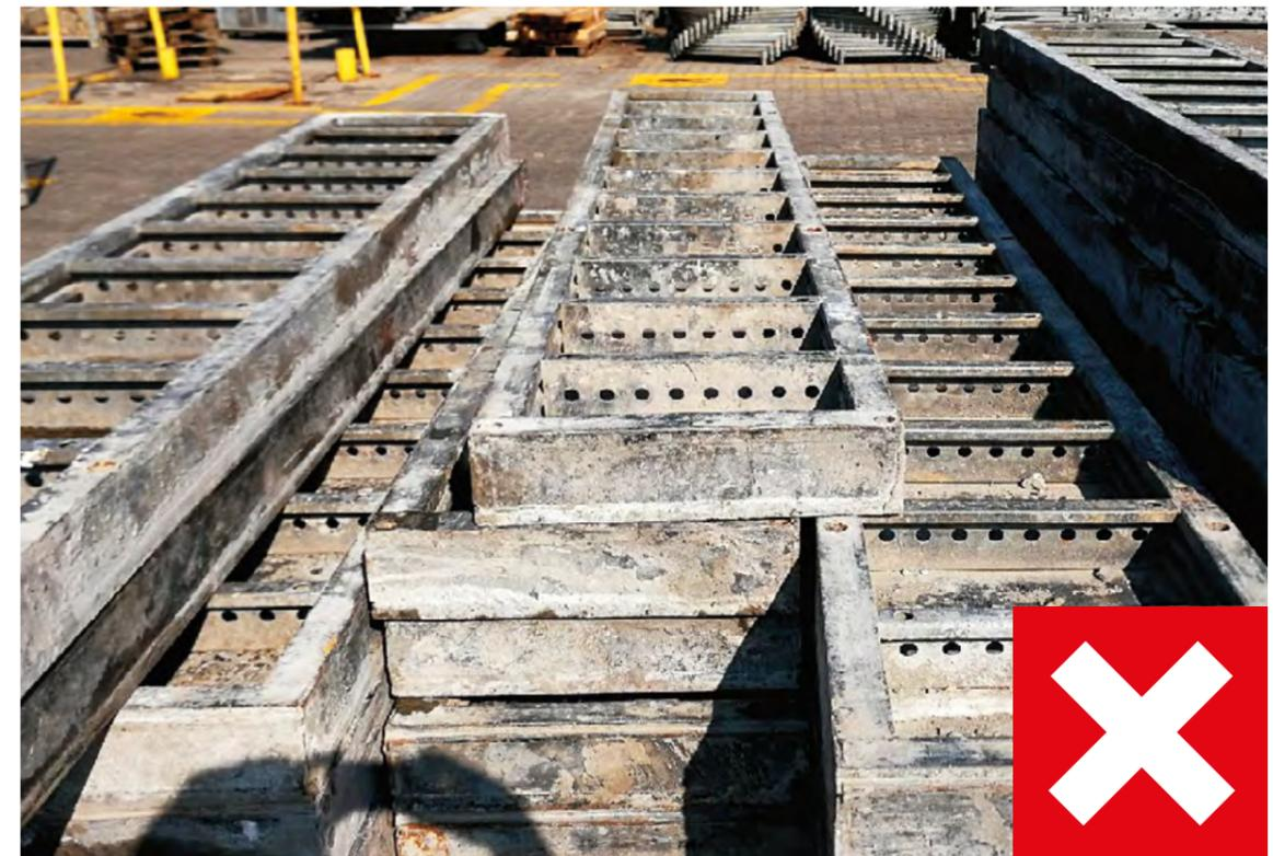
**Abbildung 12** Unsachgemäß vorbereiteter Transport: Die MANTO Schalungspakete liegen mit der Schalung nach unten und sind ungebündelt.
