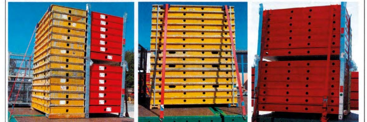
TOPEC Tafeln in speziellen Ladungsträgern und TOPEC Tafeln mit zwei Niederzurrgurten (STF ≥ 300 daN, LC = 2.500 daN), Kantenschonern und Anti-Rutschmatten gemäß Seite 1 und Lichtbilddokumentation sichern. Gurte im unmittelbaren Bereich der Holzauflage / des Stahlbandes anbringen (Bild Mitte).
