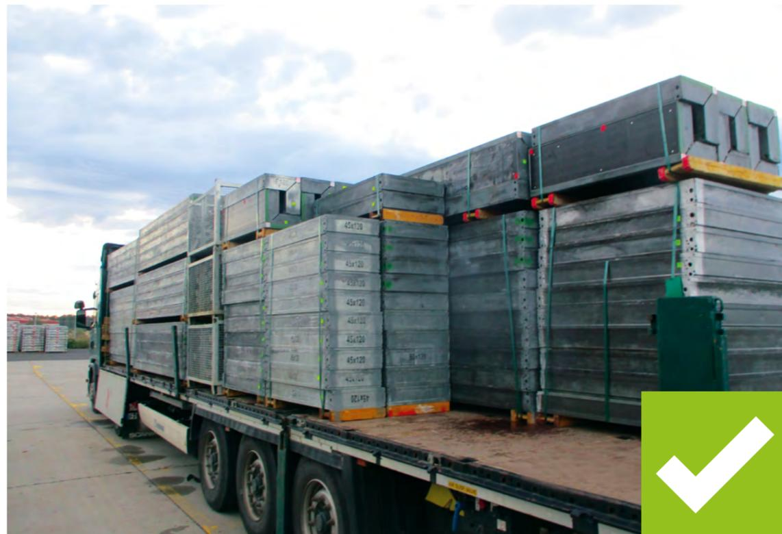
**Abbildung 2** Die MANTO Tafeln sind nach Vorgabe auf dem LKW verladen. Zur Sicherung müssen diese noch mit Niederzurrgurten verzurt werden.
