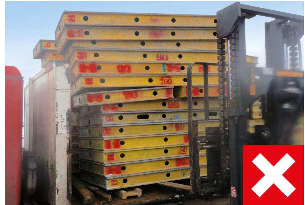
**Abbildung 15** Fehlerhaft vorbereiteter Transport: Die TOPEC Tafeln sind nicht mit Befestigungsgurten gesichert, und zwischen den 180x90-Tafeln wurden 90x90-Tafeln abgelegt. Dadurch besteht die Gefahr, dass das Paket nach Anheben durch den Stapler auseinanderfällt.
