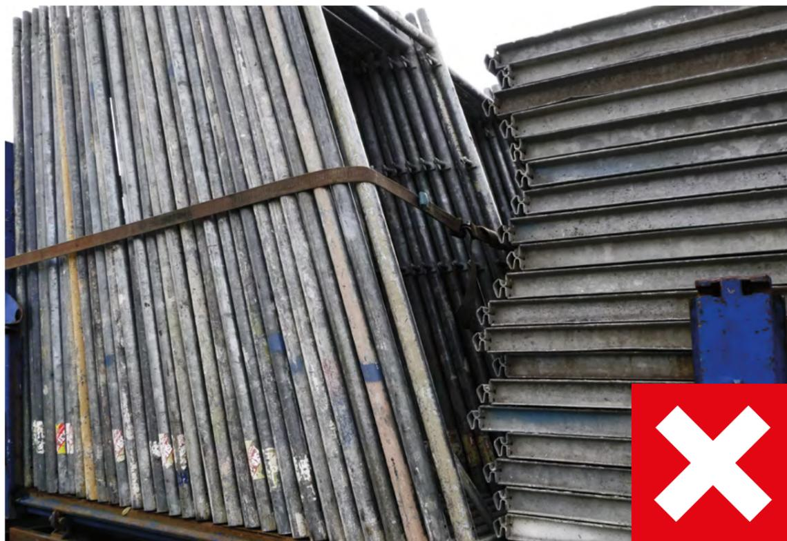
**Abbildung 14** Nicht ausreichende Ladungssicherung bei der Vorbereitung für den Transport: Entladen mit dem Gabelstapler ist nicht möglich, und es besteht die Gefahr, dass die Ausrüstung nach Lösen der Befestigungsgurte auseinanderfällt.
