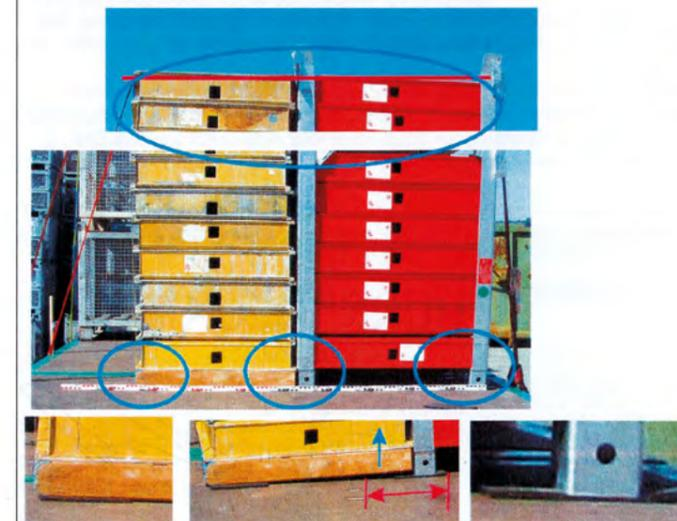
Bei der Verladung ist auf gleiche Höhe zu achten (max. 15 Tafeln), Anti-Rutschmatten (ARM) in ausreichender Länge, so dass immer zwei Ladeeinheiten auf einer ARM stehen (Bild Mitte unten), Gurtwinkel (sin) >75°.
