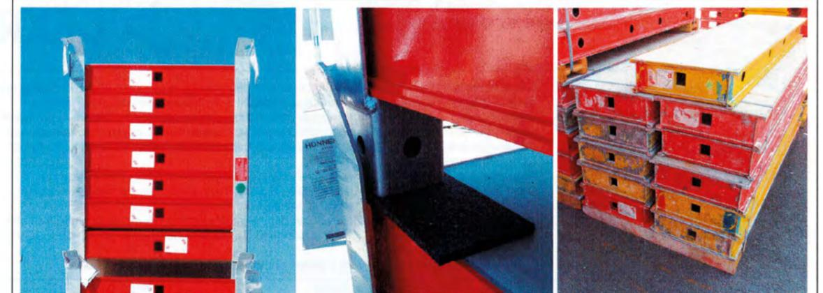
Übersicht Ladung, TOPEC Tafeln in speziellen Ladungsträgern (→ Anti-Rutschmatte bei gestapelten Ladungsträgern) und TOPEC Tafeln als Einzelladung mittels zwei Stahlbänder (19 mm x 0,65mm) pro Ladeeinheit gesichert.
