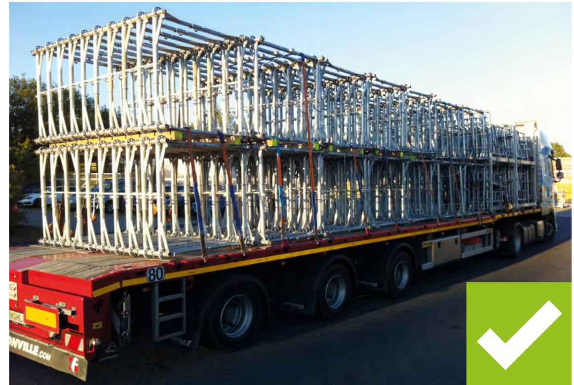
**Abbildung 8** Sichere und ordnungsgemäße Verladung von ST 60. Die Ladung steht auf Anti-Rutschmatten und ist durch Niederzurrurte fixiert.
