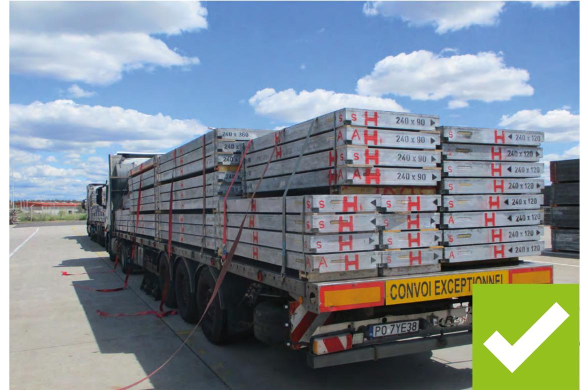
**Abbildung 3** Vorbereitung des sicheren Transports von PLATINUM Schalung. Zur Ladungssicherung müssen die restlichen Niederzurrgurte noch befestigt werden.
