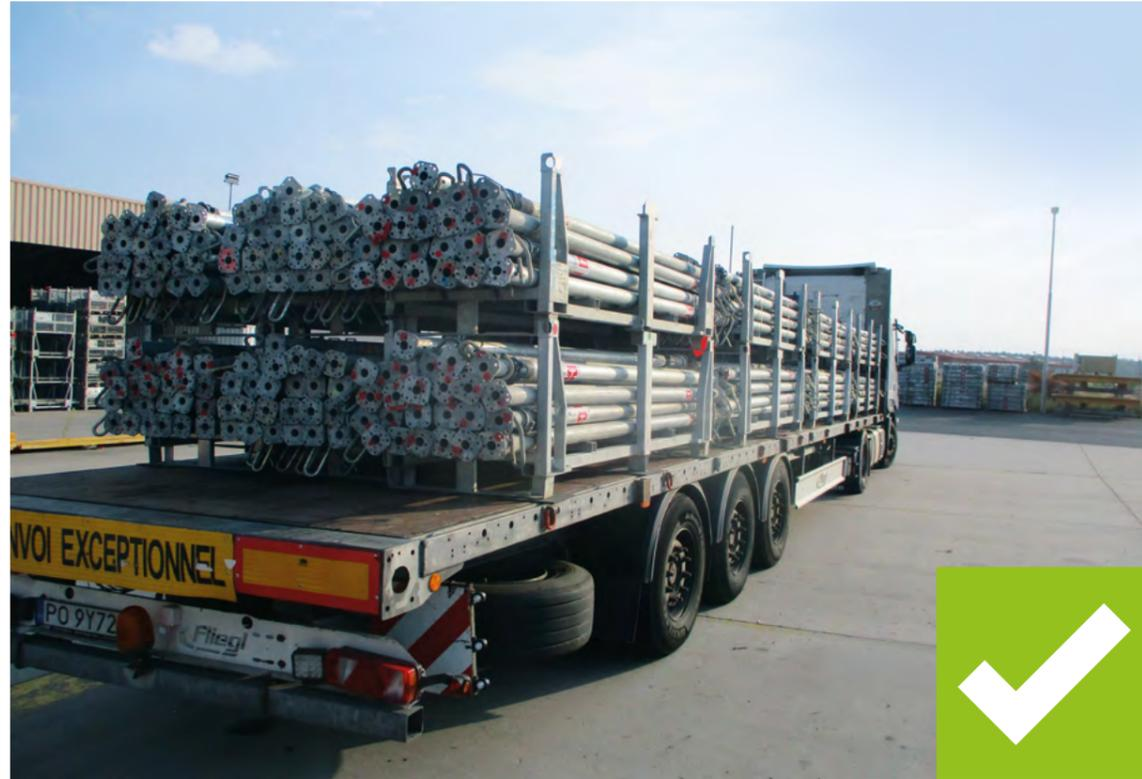
**Abbildung 1** Vorschriftsgemäße Vorbereitung von EUROPLUSnew Stahlrohrstützen für den Transport. Die Stützen sind in Euro-Stapelgestellen verpackt und stehen auf Anti-Rutschmatten. Die Verzurrung mit Niederzurrgurten hat noch zu erfolgen.
