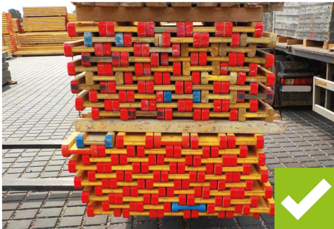
**Abbildung 6** Nach Transportrichtlinien gestapelte H20 Träger: Trägerpakete mit Unterleghölzern getrennt, die Trägergurte verkeilen sich ineinander und stabilisieren so die Gesamtkonstruktion.
