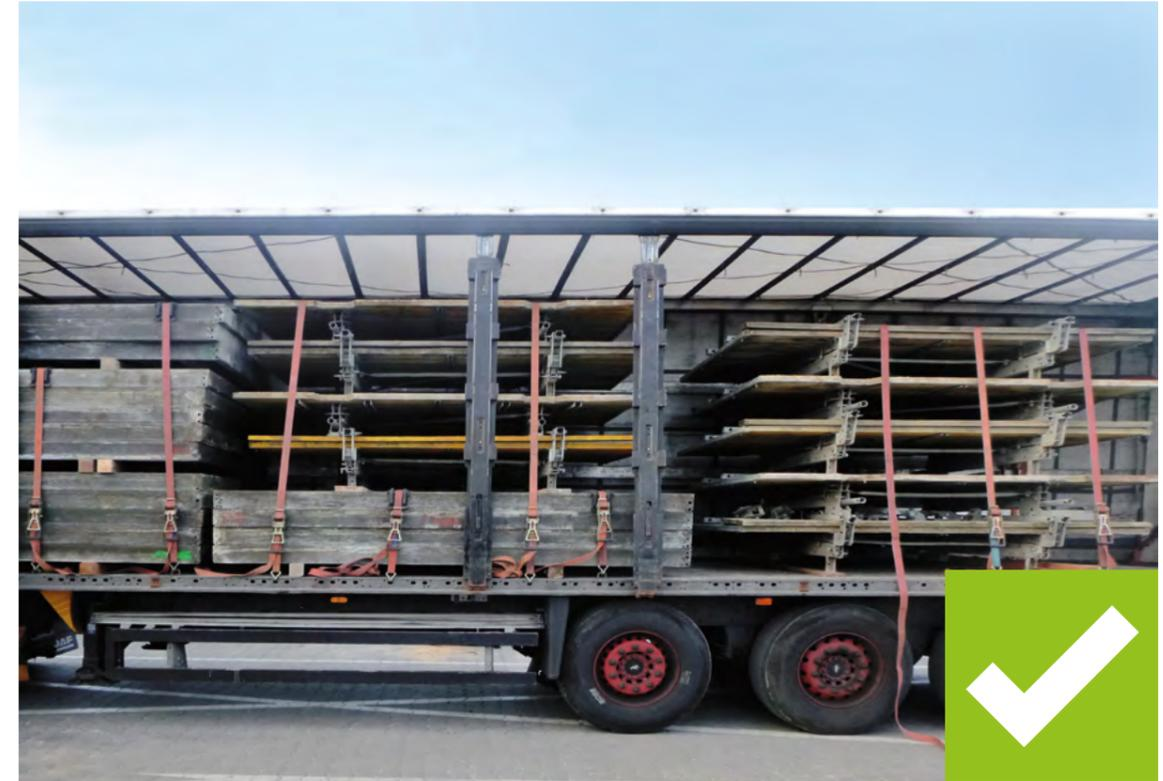
**Abbildung 7** Nach Vorschrift vorbereiteter Transport von MANTO XXL Tafeln und Klappgerüsten. Die Tafeln links sind zu zwei Paketen mit der Maximalhöhe von 5 Tafeln sowie einem weiteren Paket zu 3 Tafeln gestapelt, die jeweils mit Unterleghölzern voneinander getrennt sind. Die übrigen 4 Transporttafeln wurden einzeln daneben gestapelt. Ein Niederzurrurt muss noch festgezurt werden.
