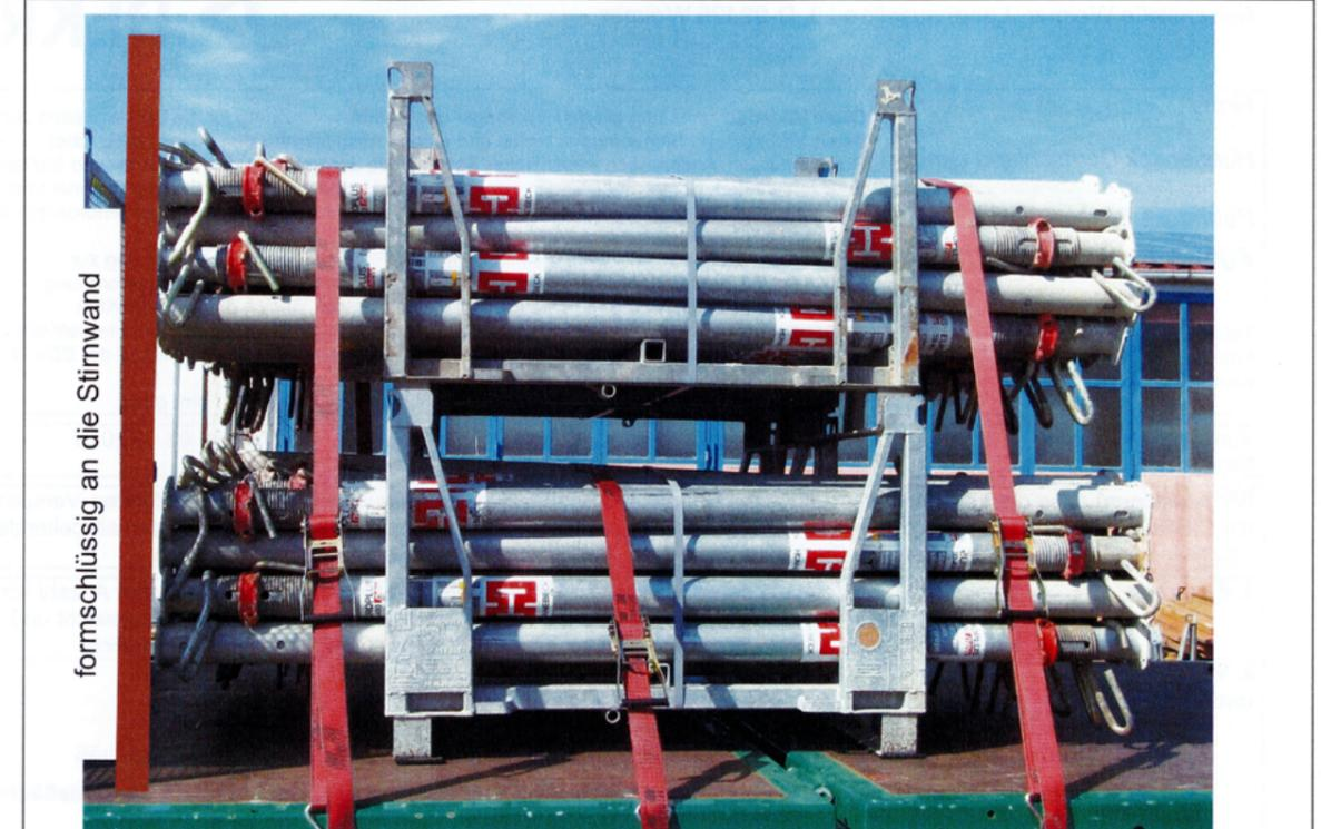
Europlus-Stützen in Ladungsträgern (Gestellen) formschlüssig an einer geeigneten Stirnwand verladen und mit insgesamt drei Niederzurrgurten [STF ≥ 300 daN; LC = 2.500 daN] sichern, wobei die unteren beiden Ladungsträger (Gestelle) mit einem Gurt mittig und die oberen Ladungsträger (Gestelle) mit zwei Gurten außerhalb des Gestells gesichert werden. Anti-Rutschmatten (ARM) in ausreichender Größe/Stärke und Festigkeit an den Auflageflächen verteilen.
