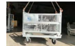
► Die Gitterbox ermöglicht das Verwahren von Verbindungsmitteln, Ankermuttern etc. Sie kann am Laufwagen befestigt und mit dem Kran versetzt werden. Die einfache Handhabung spart erheblich Kranzeit ein – eine klare Verbesserung für Lager und Logistik
