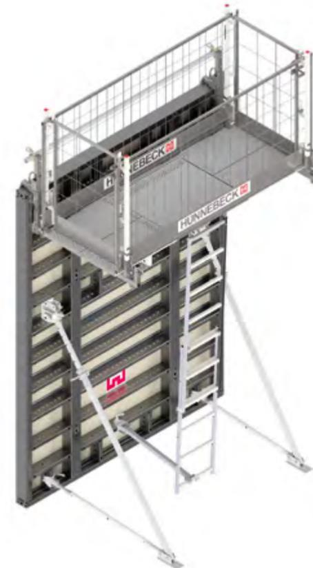
◀ Die Universal-Schalungsbühne der Lastklasse 2 (150 kg/m<sup>2</sup>) kann systemübergreifend sowohl an das RASTO® als auch an das MANTO® Schalungssystem montiert werden. Nur die jeweiligen Adapter sind systemspezifisch.
