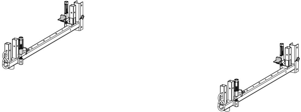
**Schritt 2** Beide Schrauben der Belaghalter der einen Bühnenkonsole lösen. Äußeren Belaghalter nach außen drehen. Inneren Belaghalter nach innen drehen.
