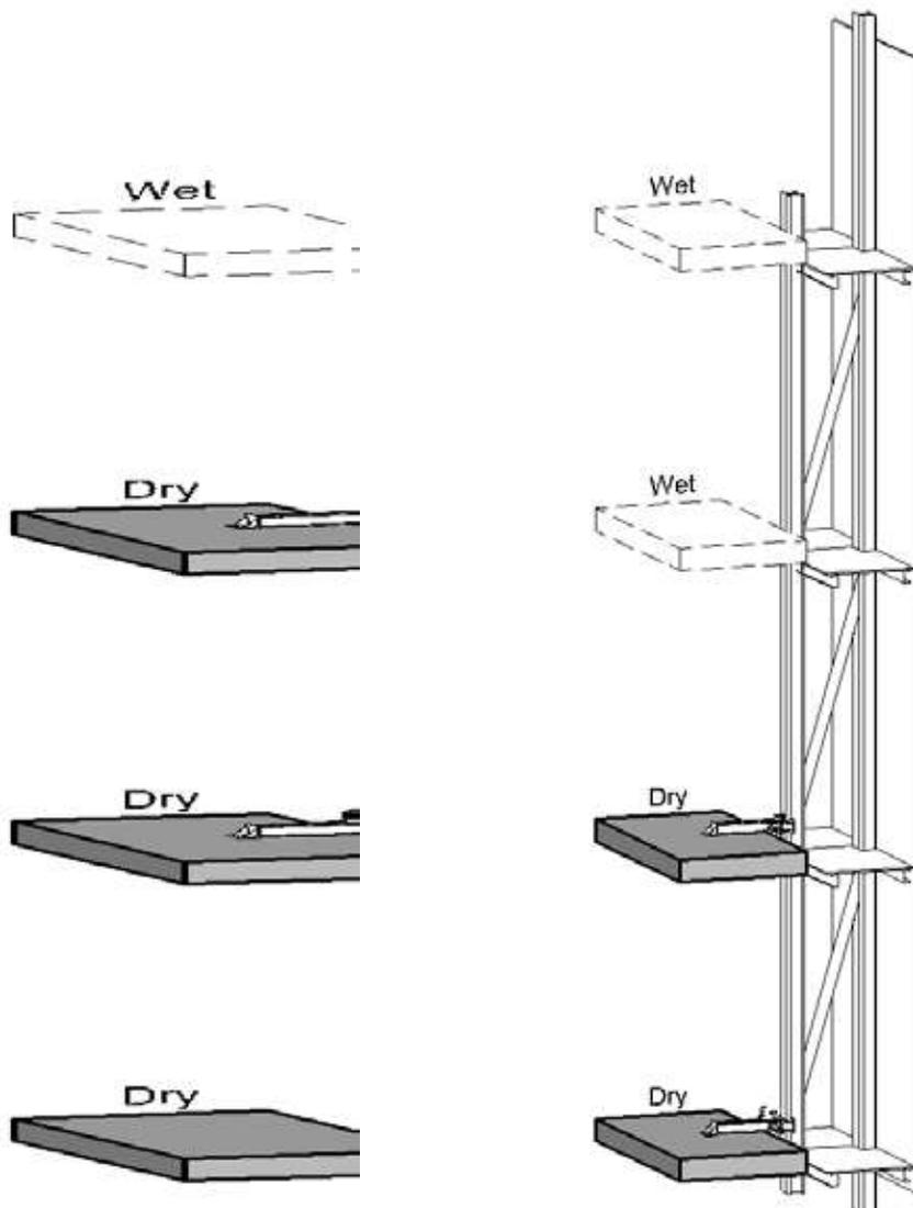
◀ Las secciones están diseñadas comúnmente de 3.0 m entre piso y piso, de todas formas, pueden ser diseñadas para pisos de entre 2.8 m a 4.3 m proporcionando una completa protección y un acceso a las distintas plataformas.
