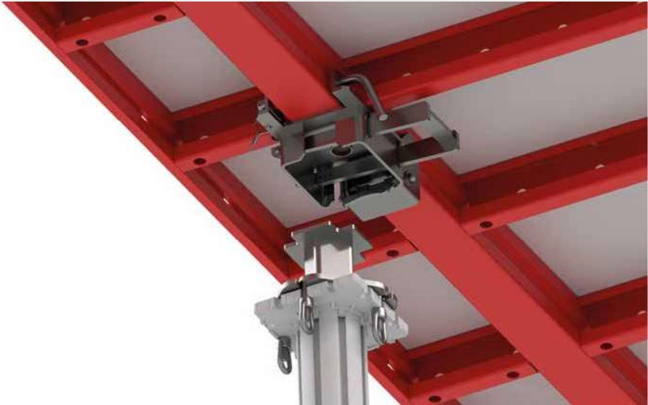
El multi- adaptador TOPMAX-GASS permite adjuntar paneles TOPMAX en combinación con el cabezal plegable TOPMAX y el soporte GASS (puntales individuales o torres). El adaptador es fijado en el soporte GASS con pernos de fijación poste-poste.
