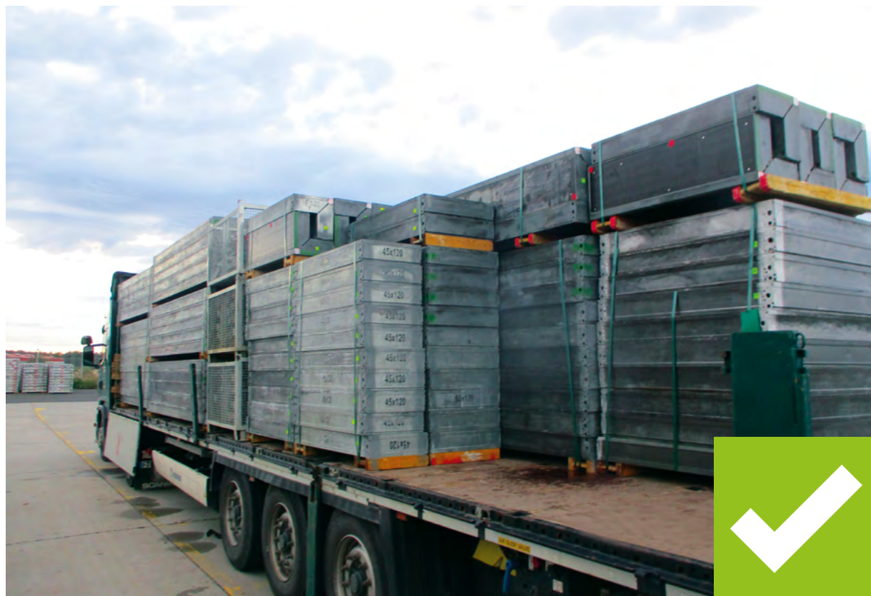
Figuur 2 De MANTO-platen worden op de gespecificeerde wijze op de vrachtwagen geladen. Om ze vast te zetten, moeten ze nog worden vastgesjord met sjiormen.
