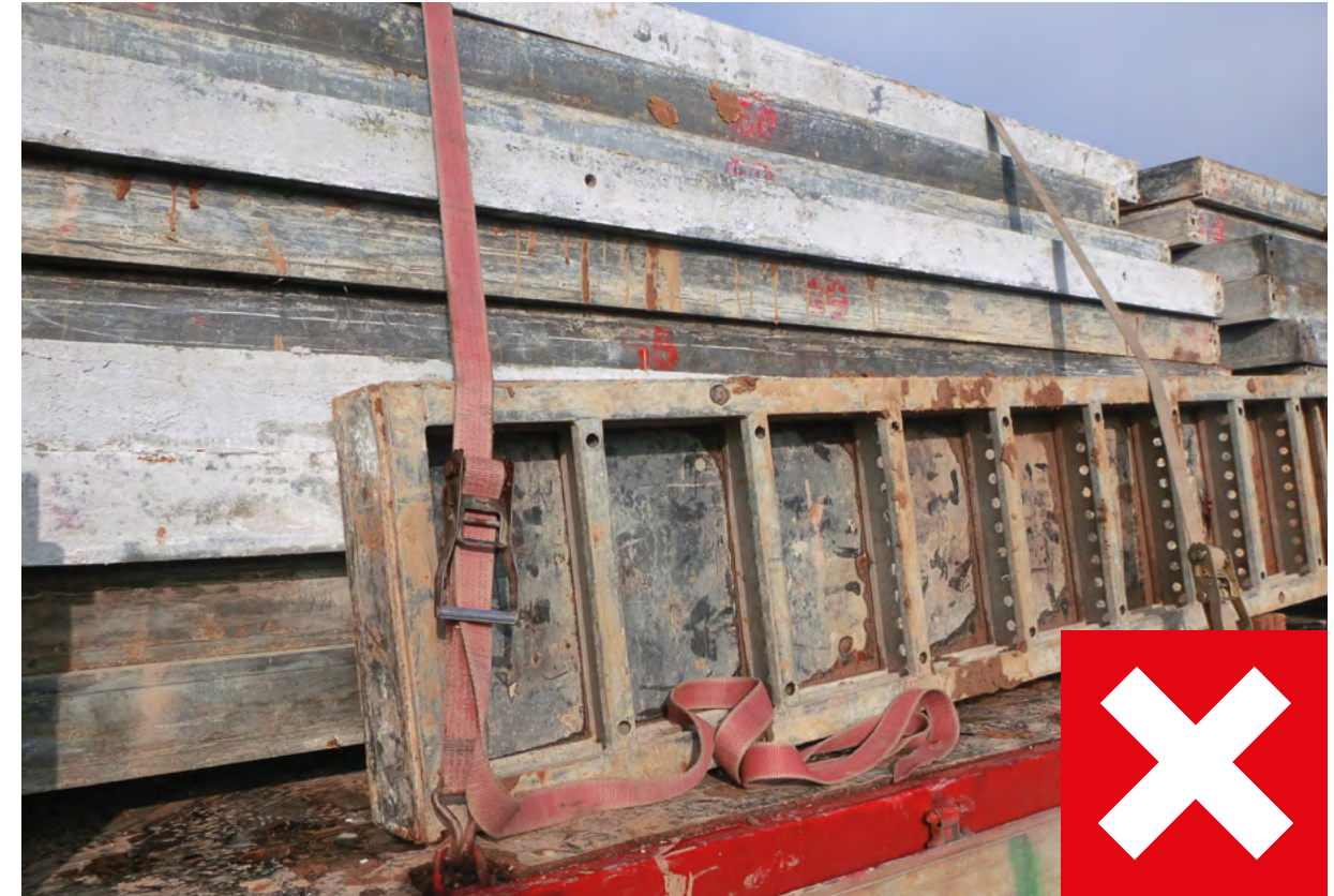
Figuur 11 De transportrichtlijnen werden niet in acht genomen. De schakelplaat is los en pakketten zijn niet gebundeld.
