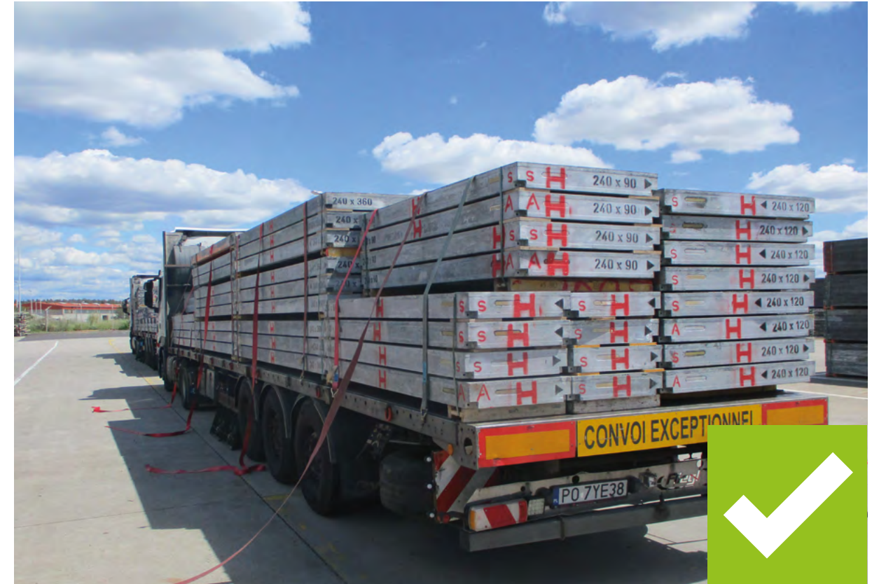
Figuur 3 Voorbereiding voor veilig vervoer van PLATINUM-bekisting. De resterende sjiormen moeten nog worden vastgemaakt om de lading vast te zetten.
