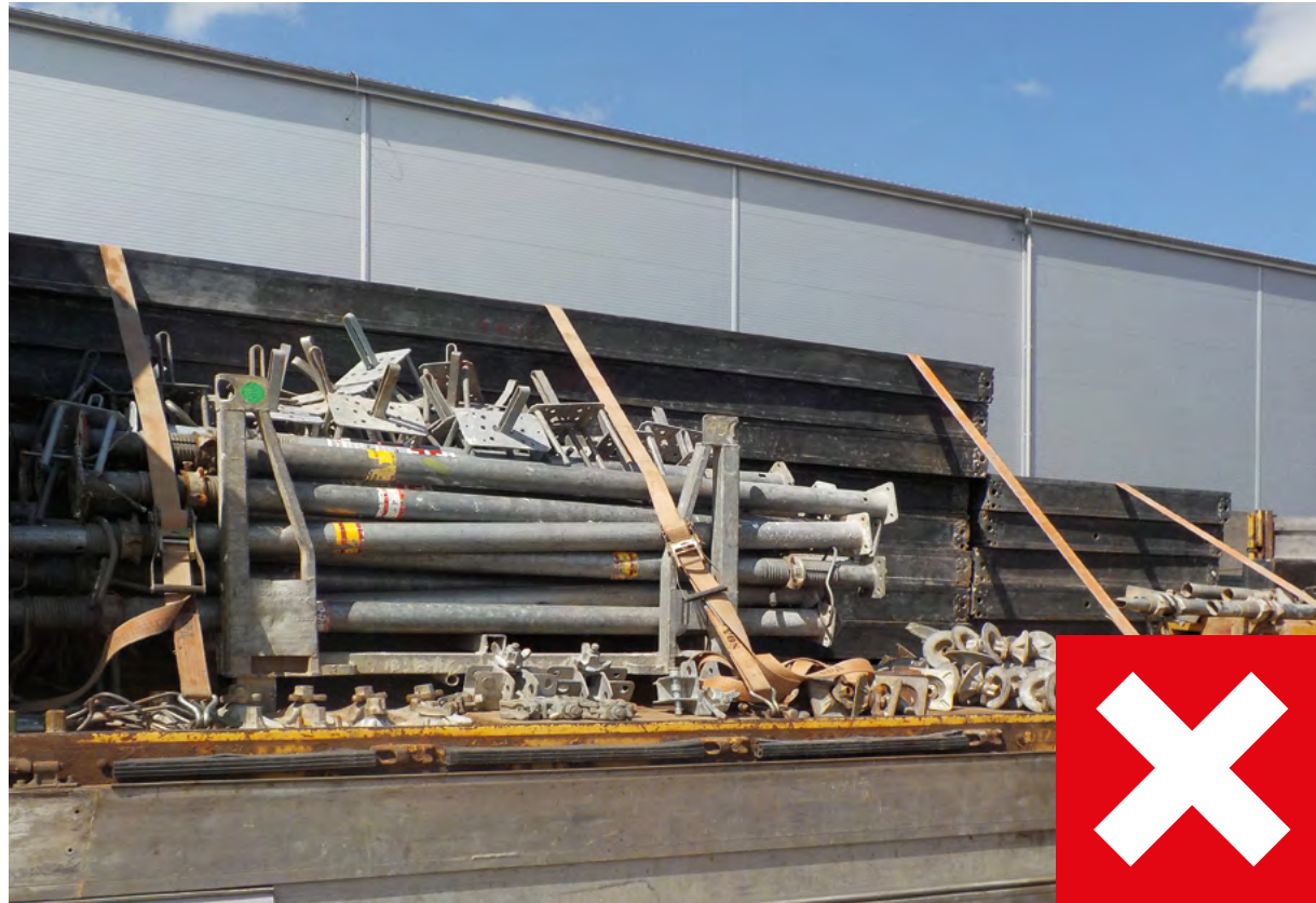
Figuur 9 Onveilig voorbereid transport: Losse accessoires zijn niet in Euro-Gitterboxen geladen en kunnen eraf vallen wanneer het voertuig begint te rijden.
