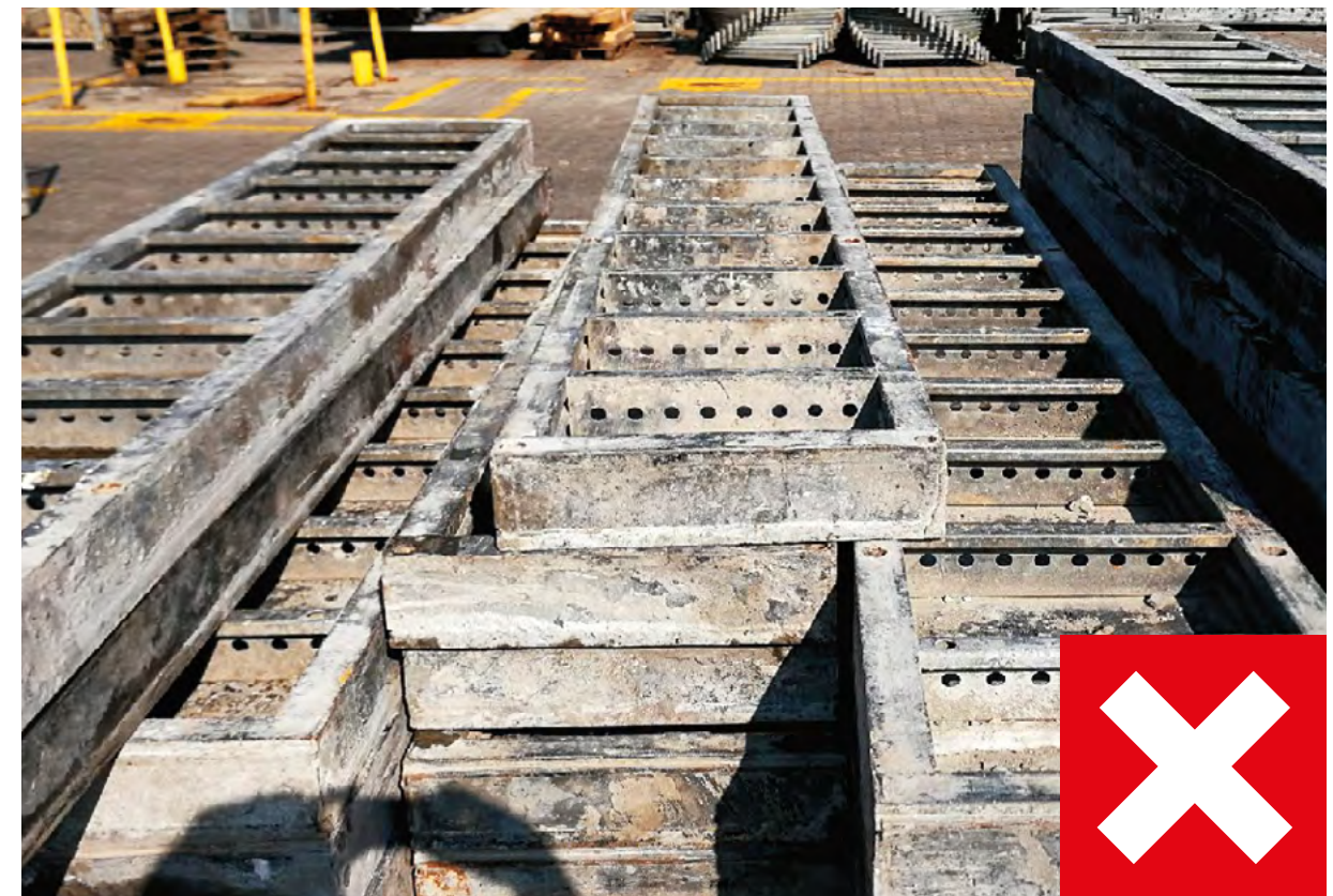
Figuur 12 Ondeskundig voorbereid transport: De MANTO bekistingsplaten liggen met de bekisting naar beneden gericht en zijn niet gebundeld.
