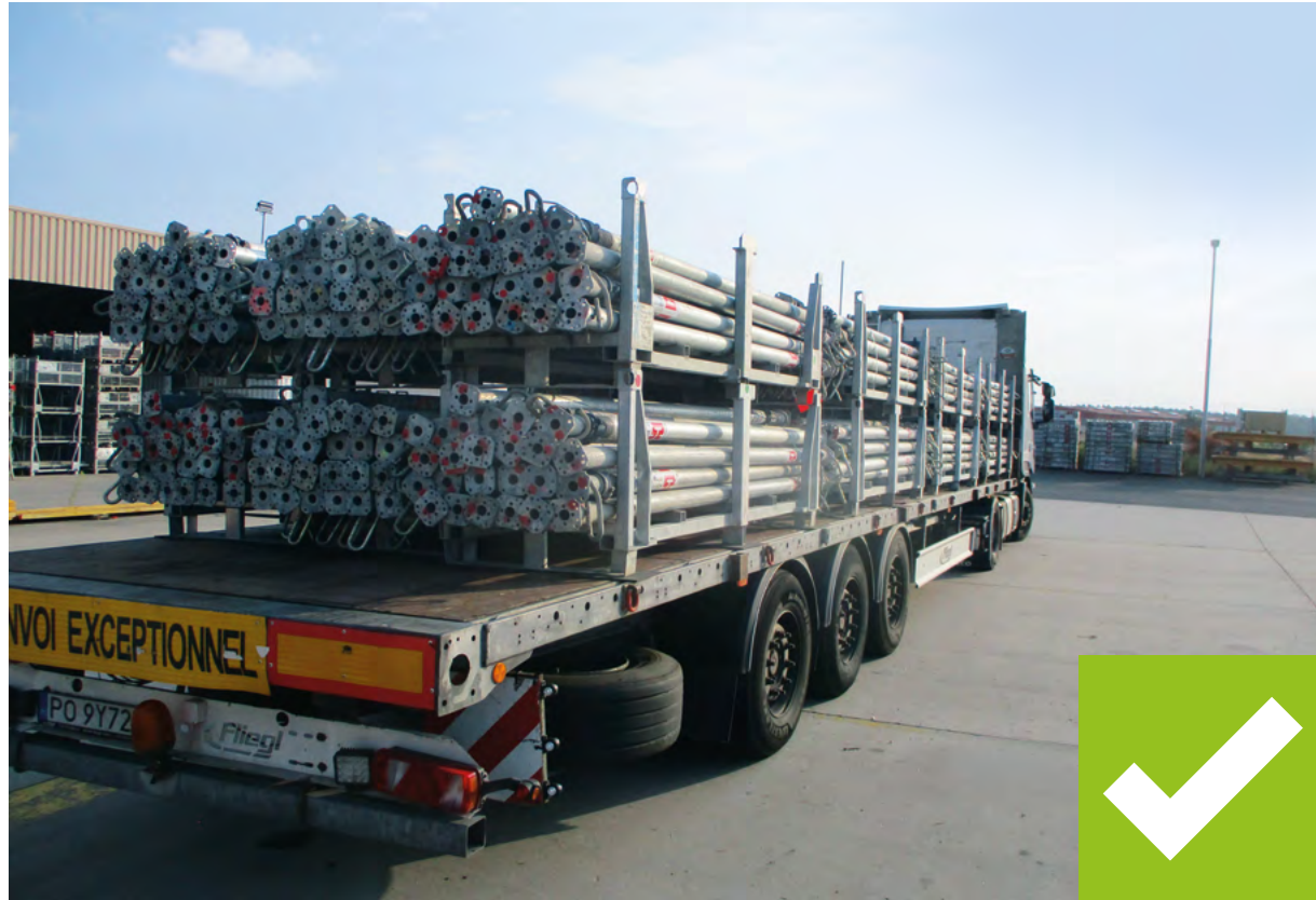
Figuur 1 Voorbereiden van EUROPLUSnew stalen buissteunen voor transport volgens de voorschriften. De steunen zijn verpakt in Euro-stapelrekken en staan op antislipmatten. Het vastsjorren met sjiormen moet nog steeds worden uitgevoerd.
