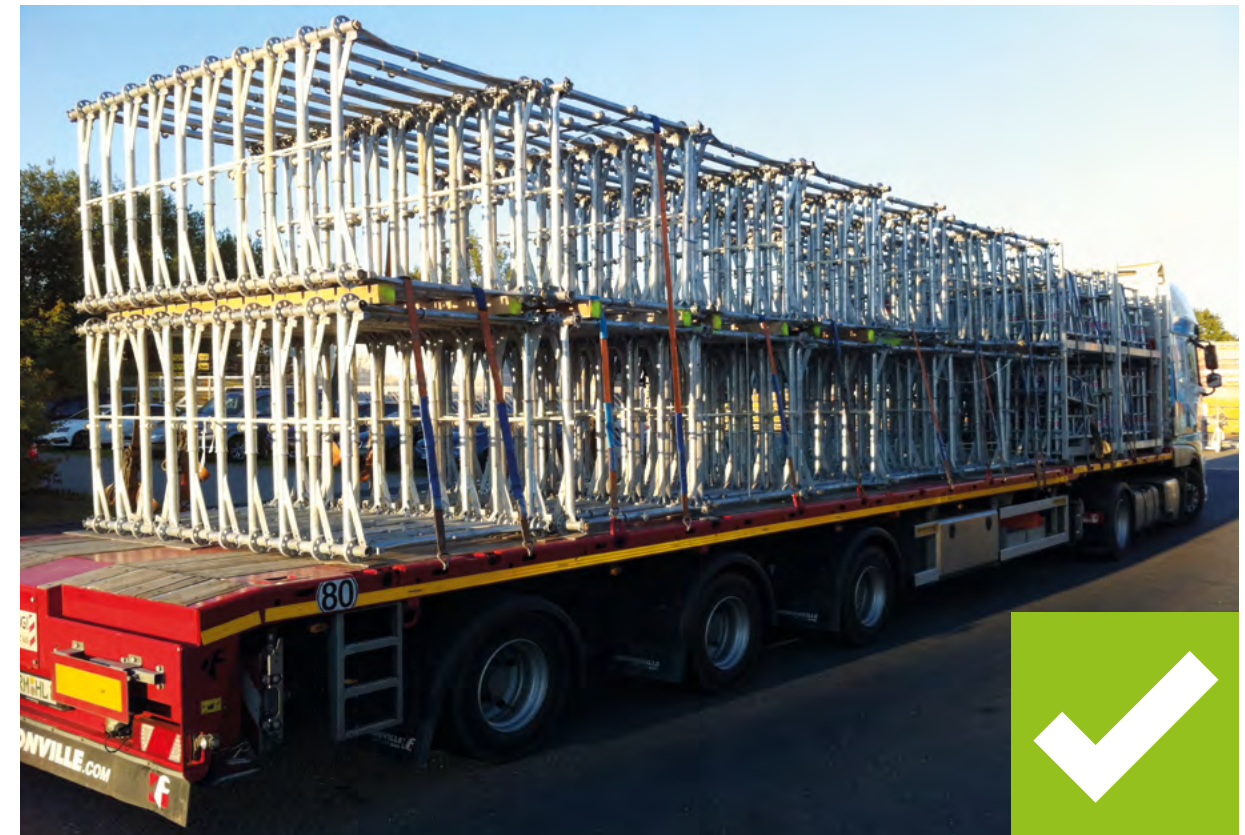
Figuur 8 Veilige en correcte belading van de ST 60. De lading staat op antislipmatten en wordt vastgezet met spanriemen.
