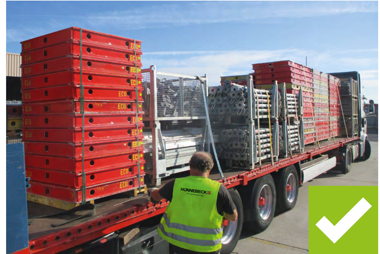
Figuur 7 Laden van TOPEC-platen, EUROPLUSnew steunen en toebehoren volgens de voorschriften: De platen worden gebundeld volgens de stapelinstructies, de steunbalken worden vastgezet in stapelrekken en de bekistingsaccessoires worden vervoerd in stapelrekken en in Gitterboxen. Alle elementen zijn bekleed met anti-slip matten. De lading wordt rechtop vastgezet met spanriemen.
