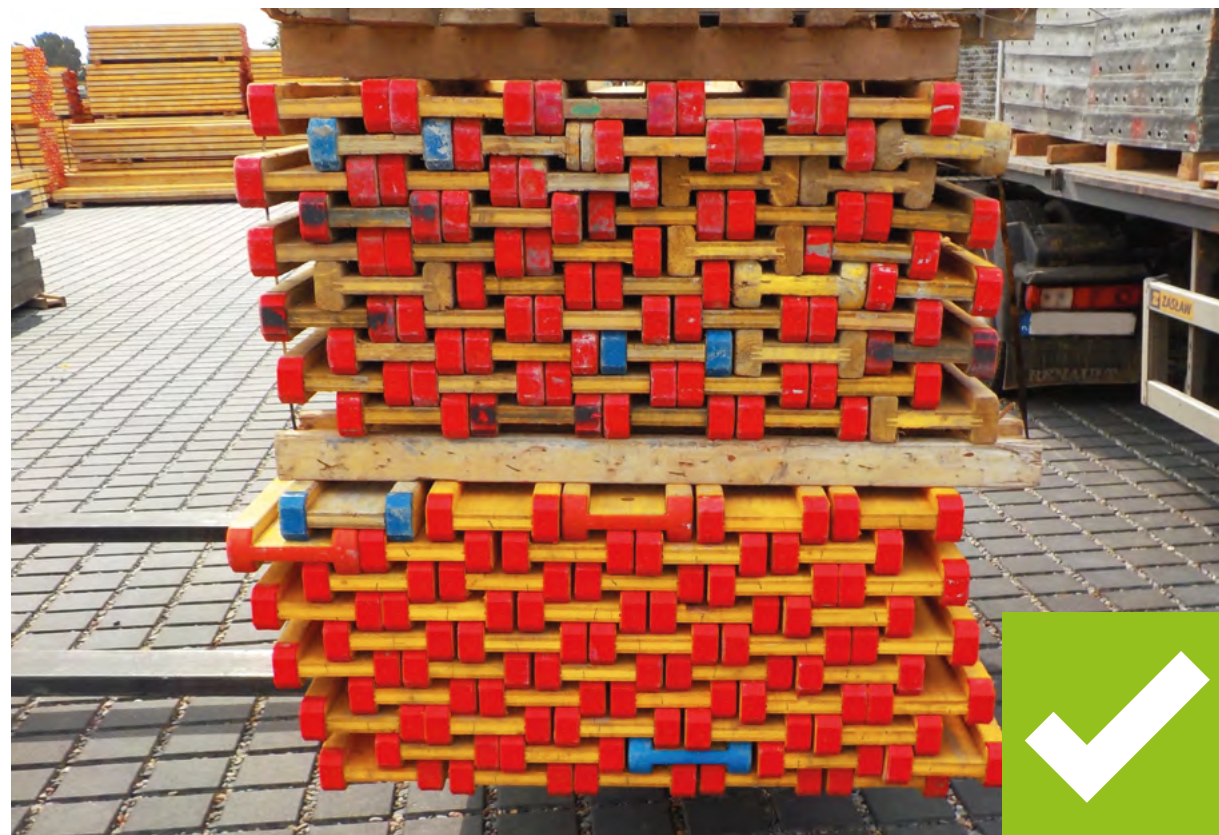
Figuur 6 H20 balken gestapeld volgens de transportrichtlijnen: De balken, die met wiggen en stuwhout zijn gescheiden, worden door de spanriemen vastgetrokken om de hele constructie te stabiliseren.
