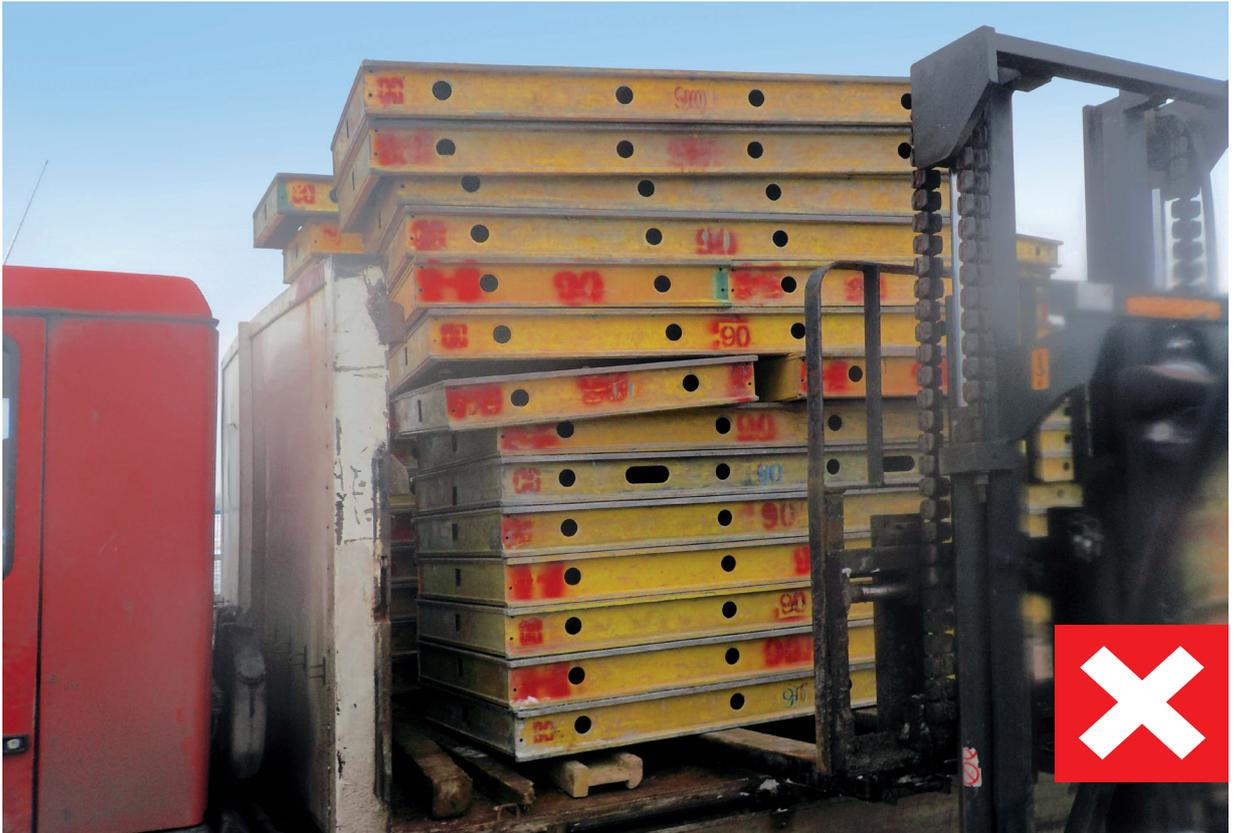
Fehlerhaft vorbereiteter Transport: Die TOPEC® Tafeln sind nicht mit Befestigungsgurten gesichert, und zwischen den 180 x 90-Tafeln wurden 90 x 90-Tafeln abgelegt. Dadurch besteht die Gefahr, dass das Paket nach Anheben durch den Stapler auseinanderfällt.
