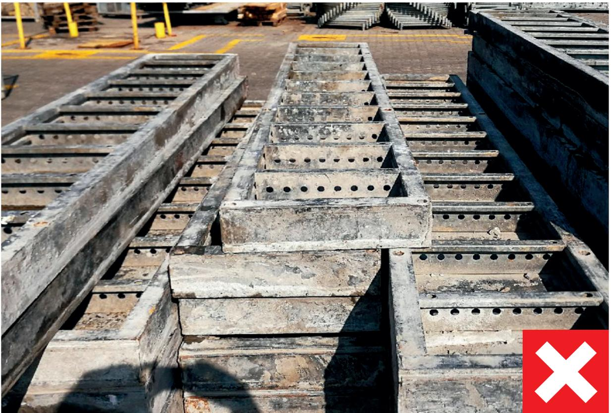
Unsachgemäß vorbereiteter Transport: Die MANTO® Schaltafeln liegen mit der Schalhaut nach unten und sind ungebündelt.
