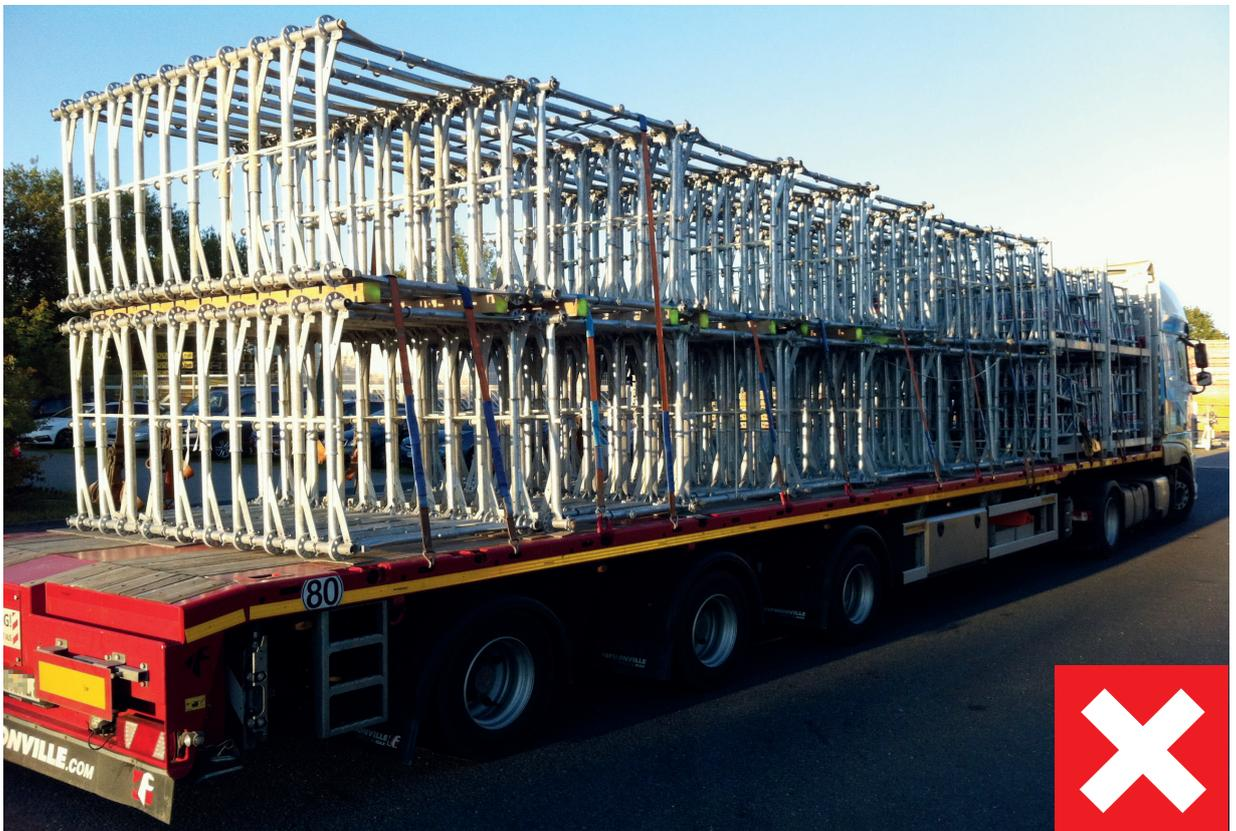
Auf der Abbildung sind die ST 60 Anfangsrahmen im montierten Zustand und mit dünnen Holzleisten versehen, damit sie transportiert werden konnten. Die Anfangsrahmen müssen aber demontiert und mit 10 Stück pro Gitterbox zurückgeliefert werden.
