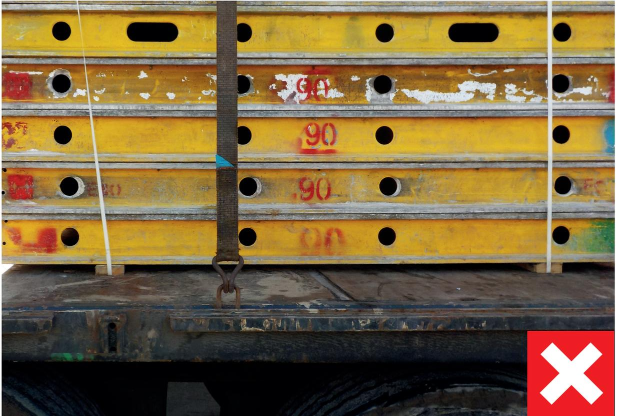
Falsch vorbereiteter Transport: Die Unterleghölzer sind zu niedrig, sodass ein Gabelstapler zum Entladen nicht darunter greifen kann.
